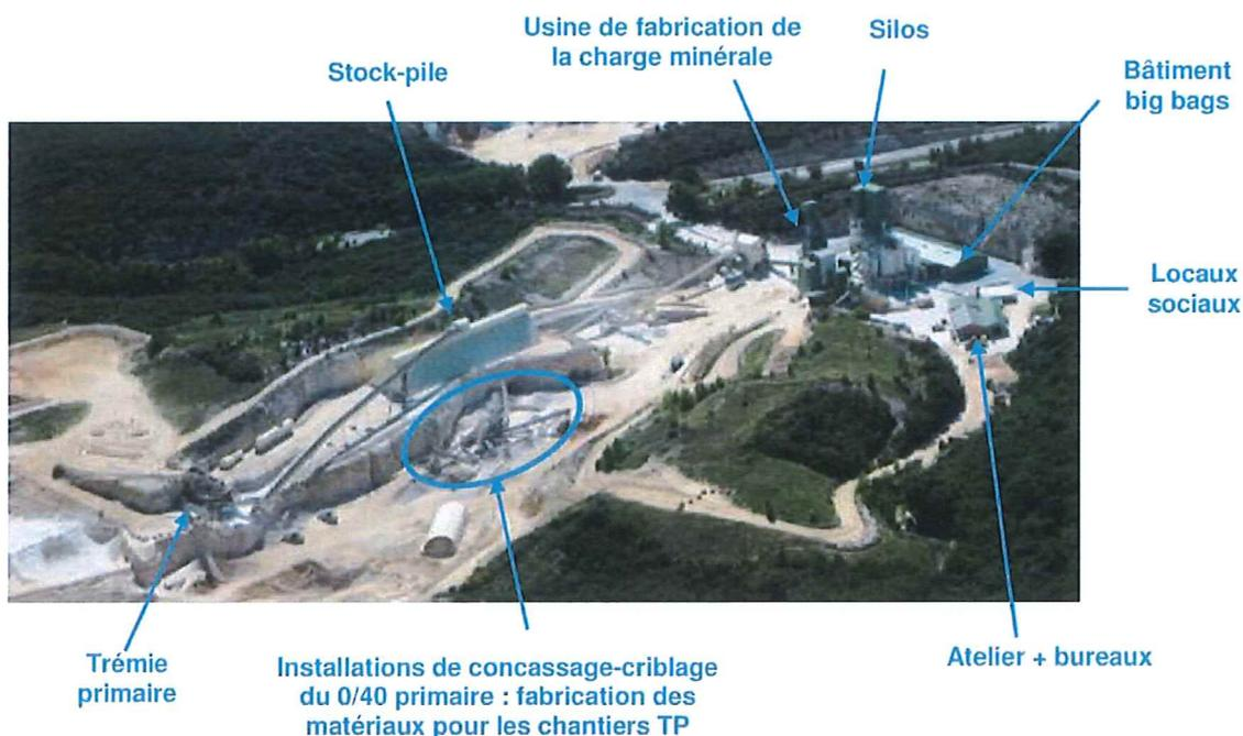
**Figure 2** : Configuration des installations de la carrière
